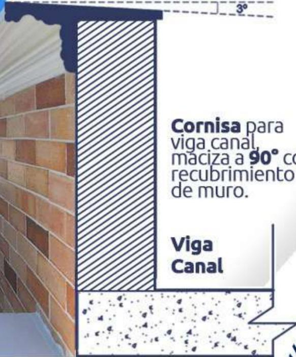
**Cornisa** para viga canal maciza a **90°** con recubrimiento de muro.
